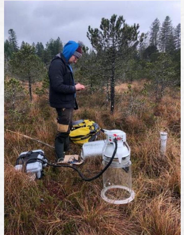
Mesure de flux de CO 2 et CH 4 par chambre d'accumulation
